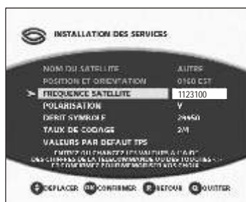
14 - Entrez les valeurs suivantes : Fréquence Satellite 1149200 Polarisation V Débit symbole 29950 Taux de codage 3/4 Puis appuyez sur la touche OK.
