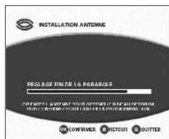
15 - Le trait de Réglage Fin de la Parabole doit être BLEU . Dans le cas contraire, ajustez l'orientation de votre antenne parabolique. Pour une réception optimale, vous devez obtenir un trait bleu.
